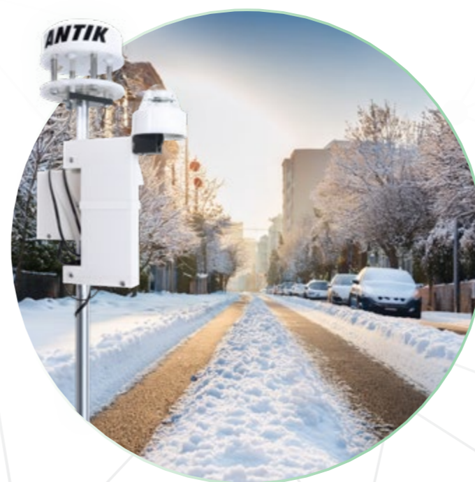
Meteostanica pre potreby údržby
